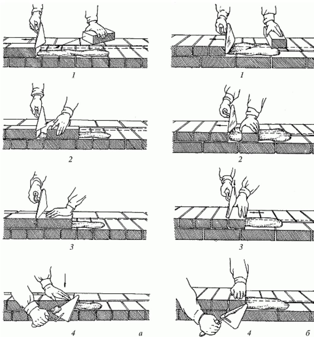
Рис. 24. Кладка способом вприжим ложкового (а) и тычкового (б) рядов наружной версты: 1–4 — последовательность действий
