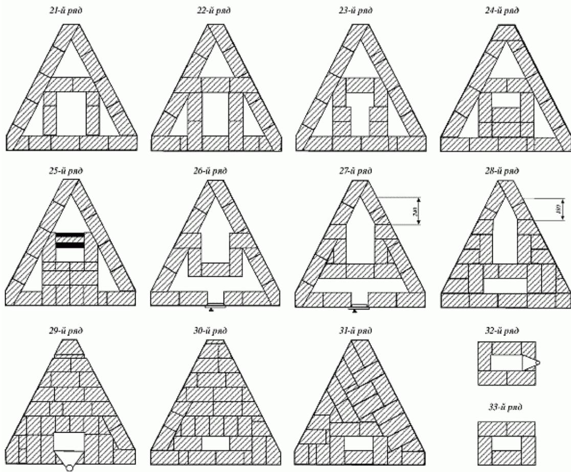
Рис. 72 (продолжение). Последовательность кладки
