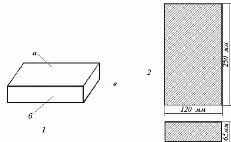
Рис. 4. Обычный керамический кирпич: 1 — стороны: а — постель; б — ложок; в — тычок;
