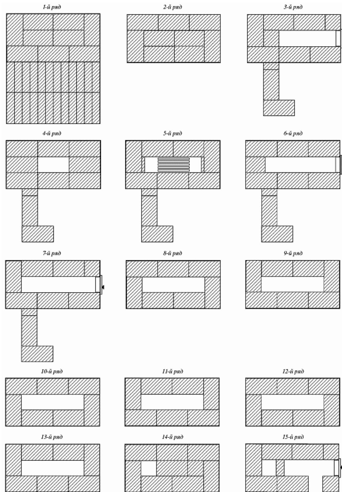
Рис. 87 (продолжение). Последовательность кладки
