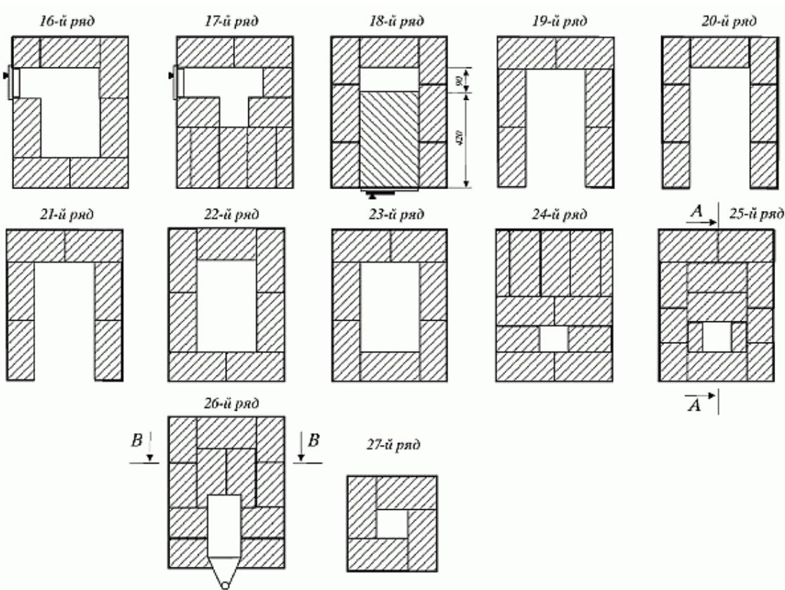
Рис. 69 (продолжение). Последовательность кладки
