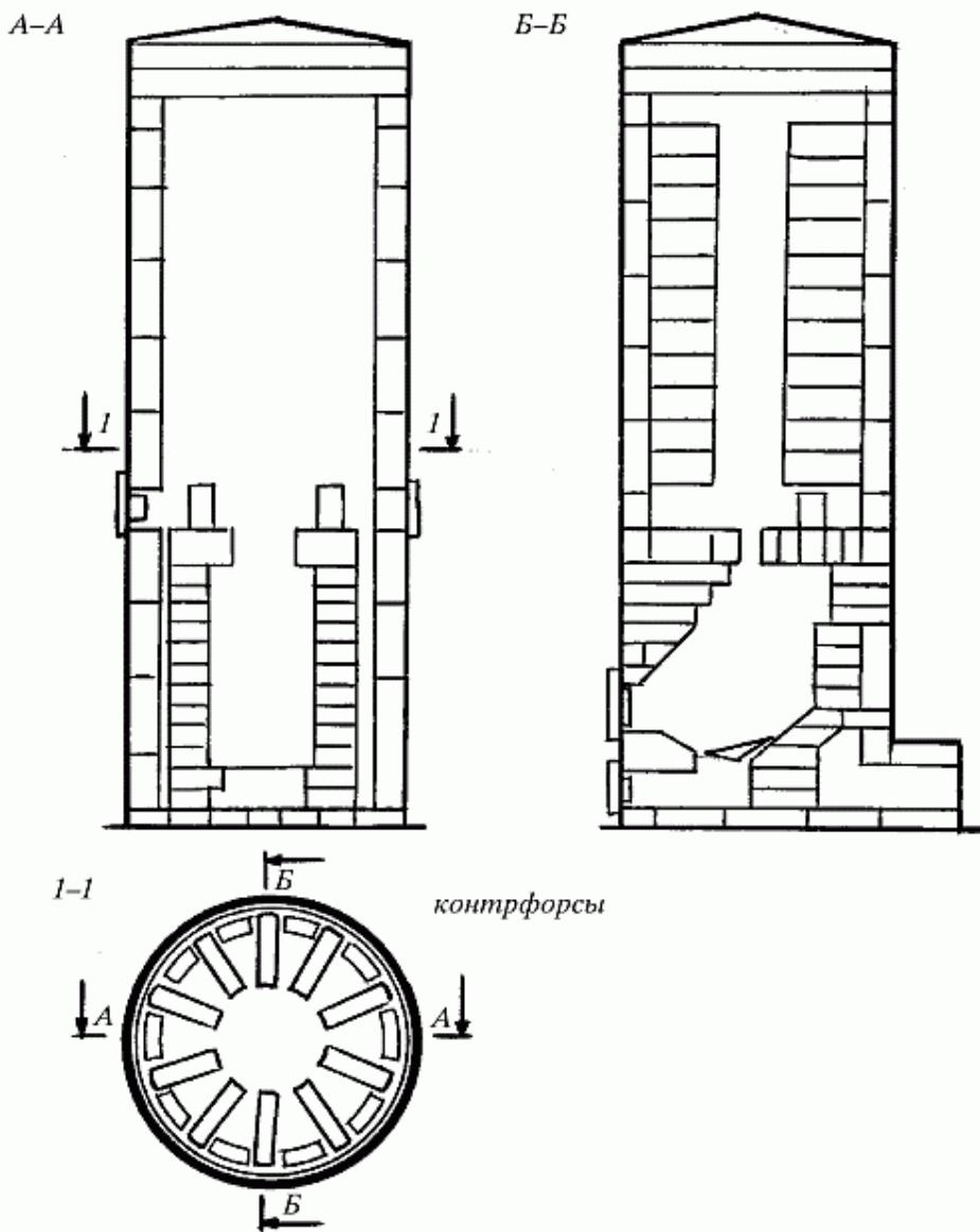
Рис. 45. Печь конструкции В.Е. Грум-Грижимайло. Устройство. Последовательность кладки
