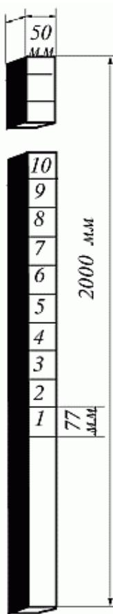
Рис. 12. Инвентарная деревянная порядовка
