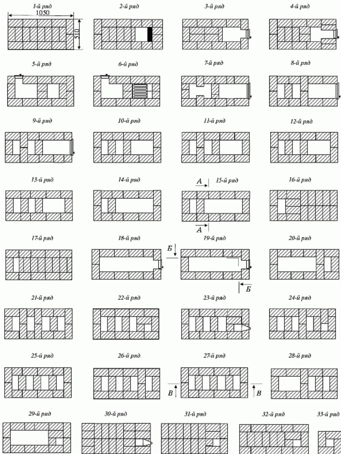
Рис. 67 (продолжение). Последовательность кладки
