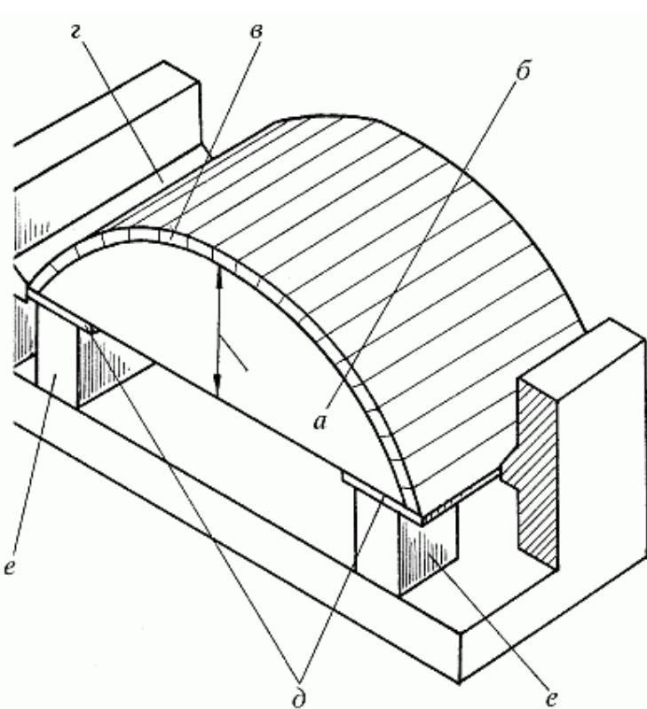
Рис. 30. Устройство опалубки для арочного перекрытия: а — подъем свода; б — пята свода; в — опалубка; г — кружало; д — подкружальные доски; е — доски
