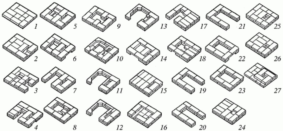
Рис. 69 (продолжение). Последовательность кладки
