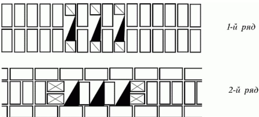
Рис. 33. Каналы в стенах толщиной 2 кирпича
