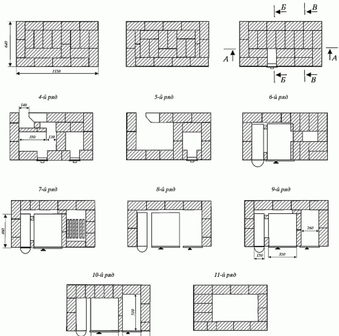
Рис. 77 (продолжение). Последовательность кладки
