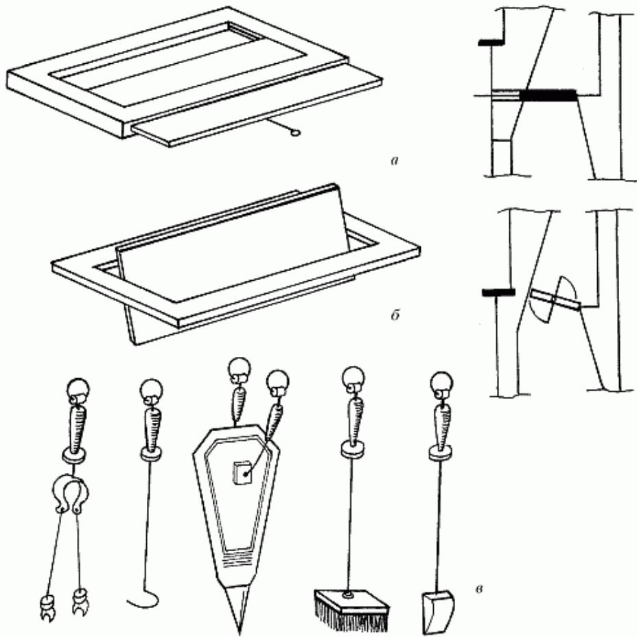
Рис. 86. Дымовые заслонки и каминная атрибутика: а — вдвижная заслонка; б — поворотная заслонка; в — атрибутика
