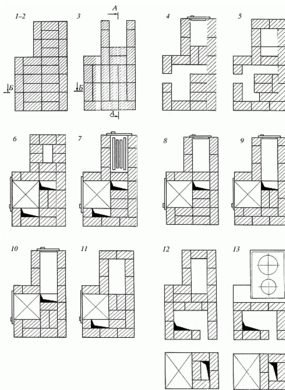
Рис. 59. Малая отопительно-варочная печь. Последовательность кладки
