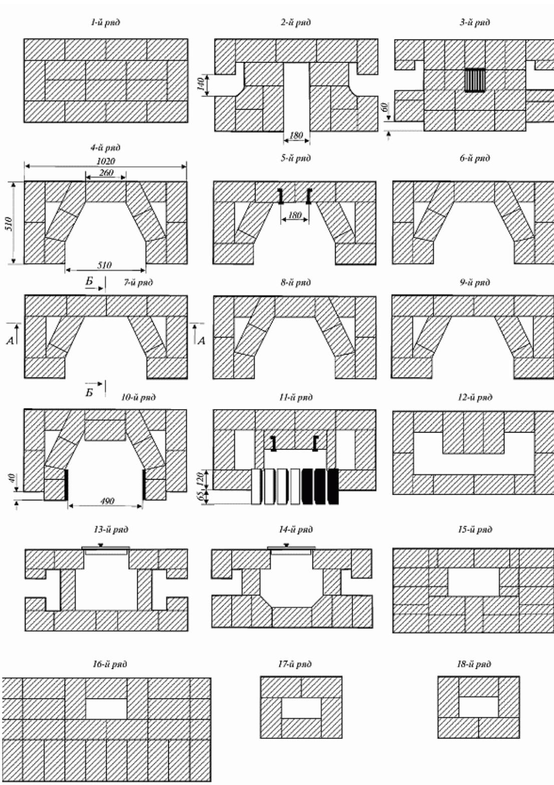
Рис. 93 (продолжение). Последовательность кладки
