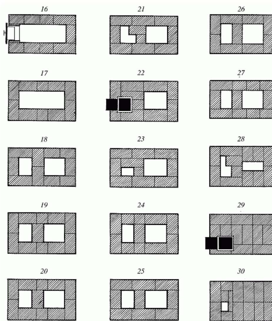
Рис. 51 (продолжение). Печь дачная. Последовательность кладки
