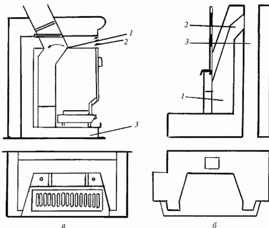
Рис. 84. Камины с боковым расположением дымового канала: а — угольный: 1 — перекидной клапан; 2 — выход нагретого воздуха; 3 — вход холодного воздуха; б — дровянной: 1 — камин; 2 — соединительный газоход; 3 — дымоход
