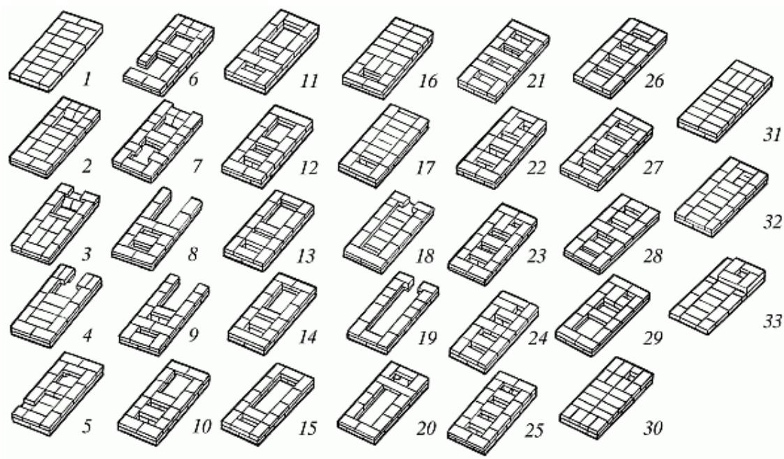
Рис. 67 (продолжение). Последовательность кладки
