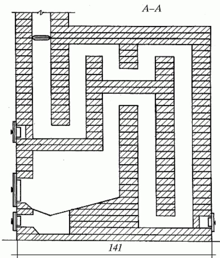
Рис. 47. Прямоугольная печь, конструкция 2. Последовательность кладки
