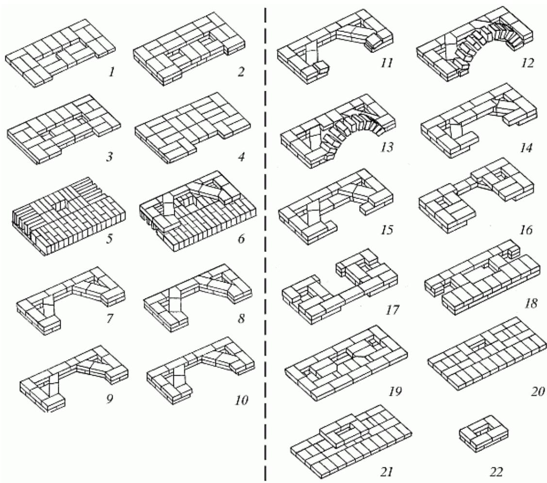
Рис. 92 (продолжение). Последовательность кладки
