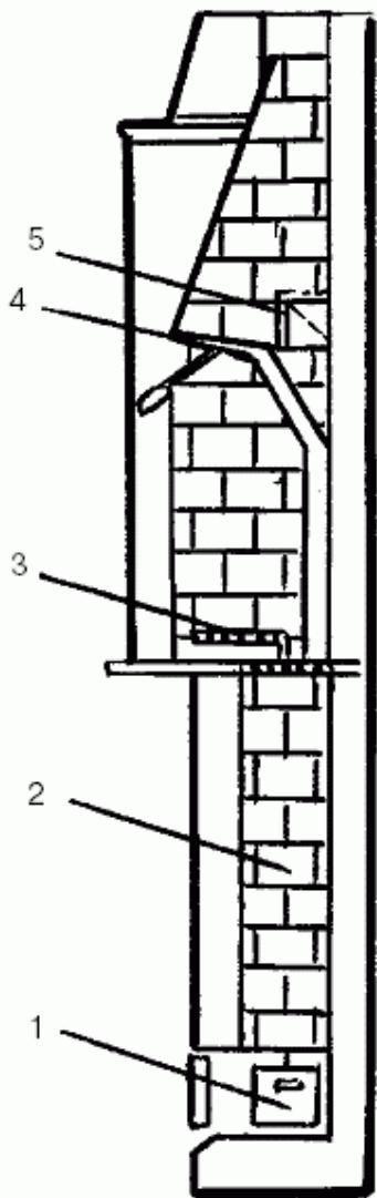
Рис. 82. Камин с чистым излучением (старогерманский): 1 — зольник; 2 — золовой канал; 3 — решетка топливника; 4 — заслонка; 5 — отверстие для чистки газохода
