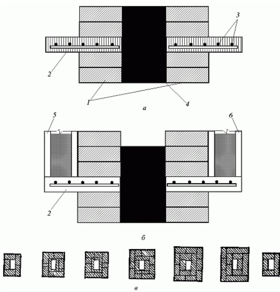
Рис. 37. Устройство распушки: а — железобетонная распушка; б — распушка в виде ящика с песком; в — последовательность кладки распушки; 1 — печная кладка; 2 — бетон; 3 — арматура; 4 — дымоход; 5 — стенки ящика; 6 — песок
