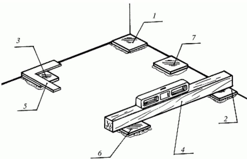
Рис. 40. Разметка горизонтальной поверхности и установка маяков: 1–3 — угловые маячные плитки; 4 — деревянная рейка; 5 — угольник; 6–7 — промежуточные маячные плитки
