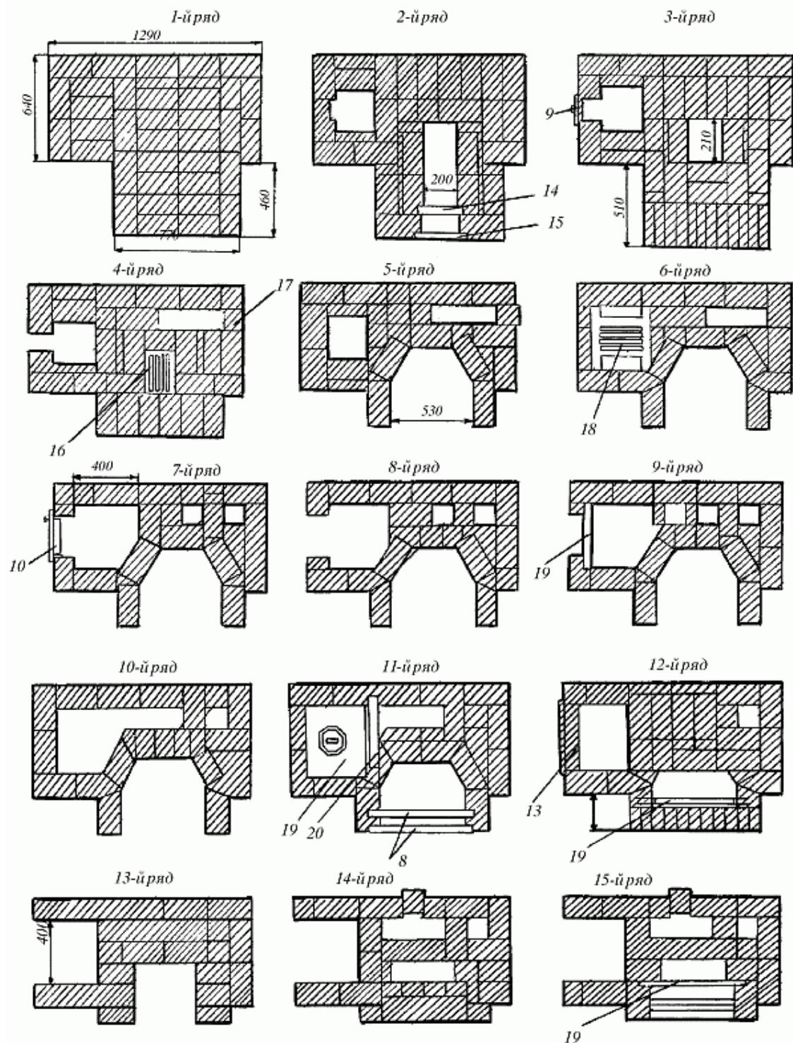
Рис. 90 (продолжение). Последовательность кладки: 1 — доска каминная; 8 — уголок стальной; 9 — дверка поддувальная; 10 — дверка топочная; 13 — рамка из стальных уголков; 14 — уголок стальной; 15 — полоса стальная; 16 — решетка колосниковая; 17 — кирпичи-вкладыши прочистные (дверки прочистные 140 x 140 мм); 18 — решетка колосниковая для топки; 19 — уголки стальные; 20 — плита чугунная с одной конфоркой
