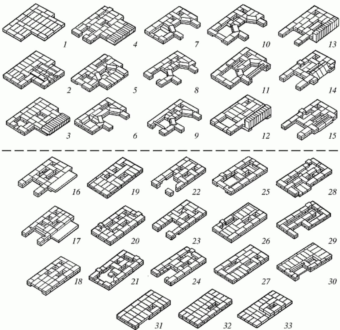
Рис. 90 (продолжение). Последовательность кладки
