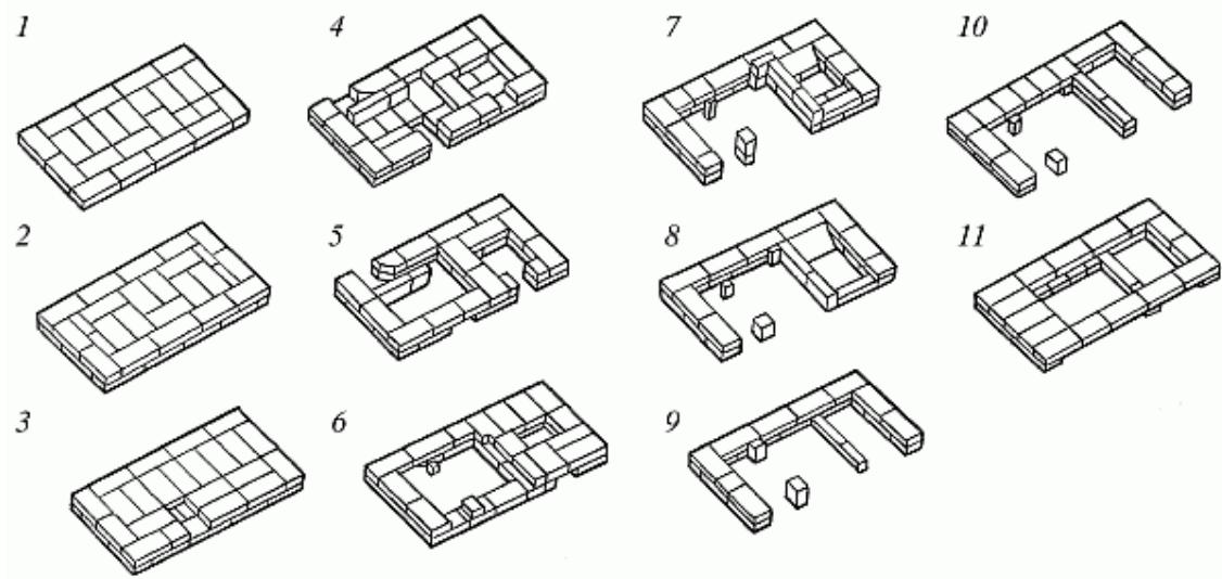
Рис. 77 (продолжение). Последовательность кладки
