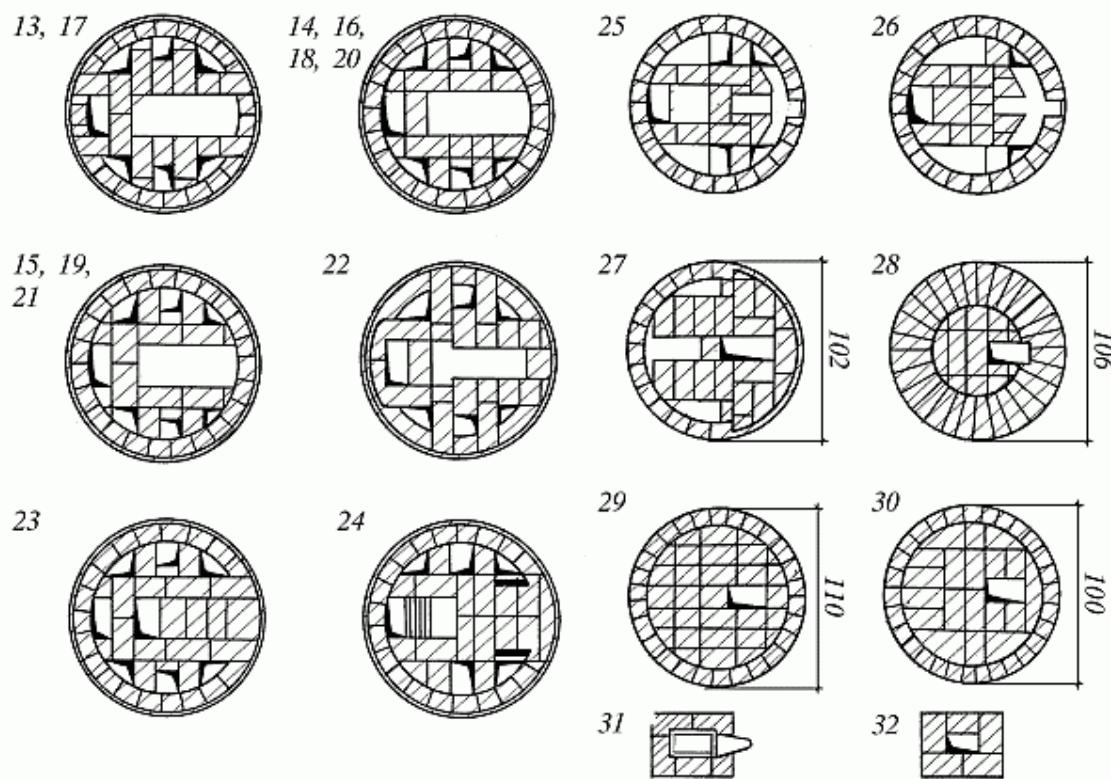
Рис. 64 (продолжение). Последовательность кладки
