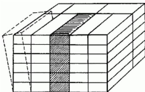
Рис. 22. Кладка без перевязки швов
