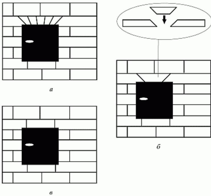
Рис. 35. Кирпичная перемычка над топочными дверками: а — клинчатая; б — в замок; в — с напуском
