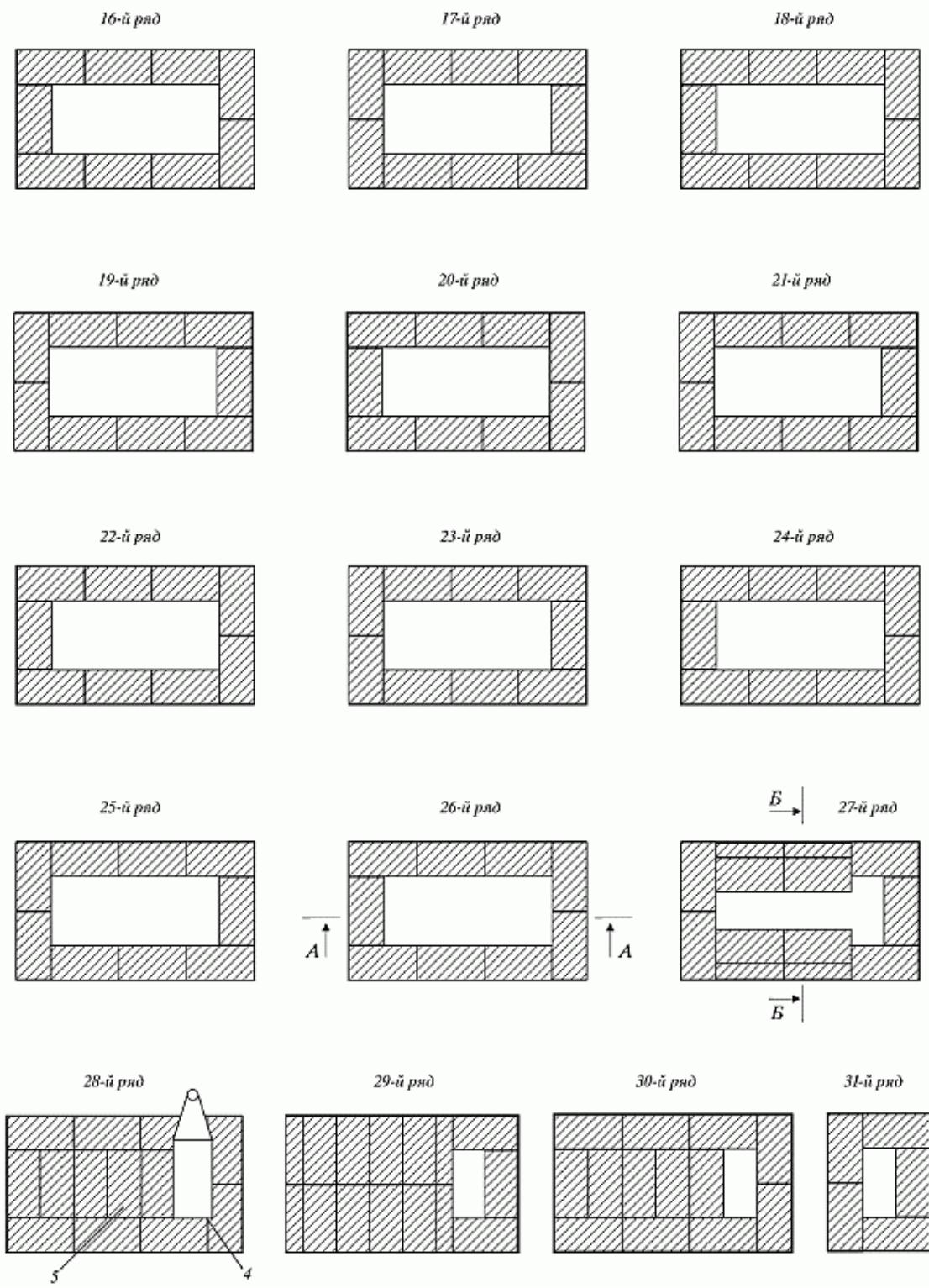
Рис. 88 (продолжение). Последовательность кладки
