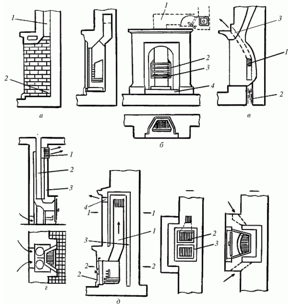
Рис. 80. Камины и каминопечи: а — камин: 1 — дымовая труба; 2 — под; б — камин с чугунной решеткой: 1 — дымовая труба; 2 — решетка; 3 — таган; 4 — под; в — камин с воздушным калорифером: 1 — коробка; 2, 3 — входной и выходной воздушные патрубки; г — камин с трубой: 1 — душник; 2 — дымовая труба; 3 — воздушный канал; д — печь-камин: 1 — подъемный газоход; 2 — топочная дверка; 3 — опускной газоход; 4 — душник
