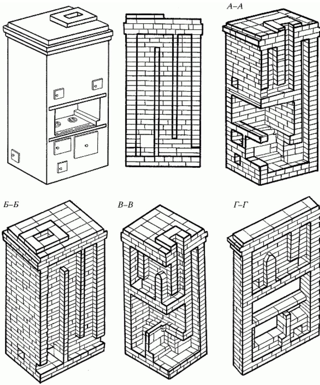
Рис. 71. Отопительно-варочная печь «Шведка»
