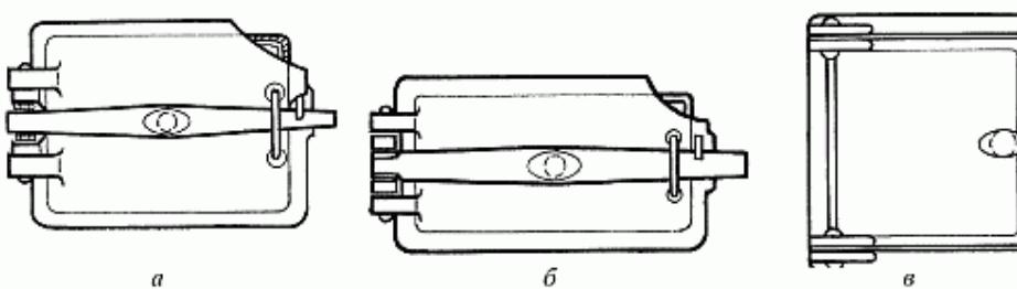
Рис. 7. Дверки печи: а — топочная герметическая; б — топочная негерметическая; в — поддувальная герметическая
