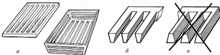
Рис. 9. Колосниковые решетки: а — корзинка; б — правильное положение решетки; в — неправильное положение решетки
