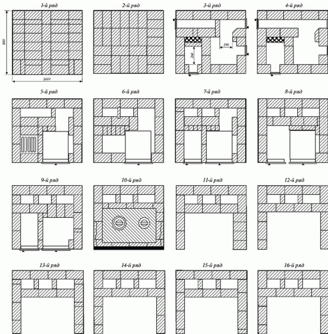
Рис. 71 (продолжение). Последовательность кладки
