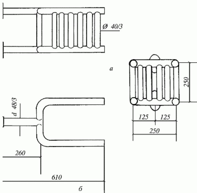
Рис. 79. Колосниковая решетка (а) и змеевик (б)
