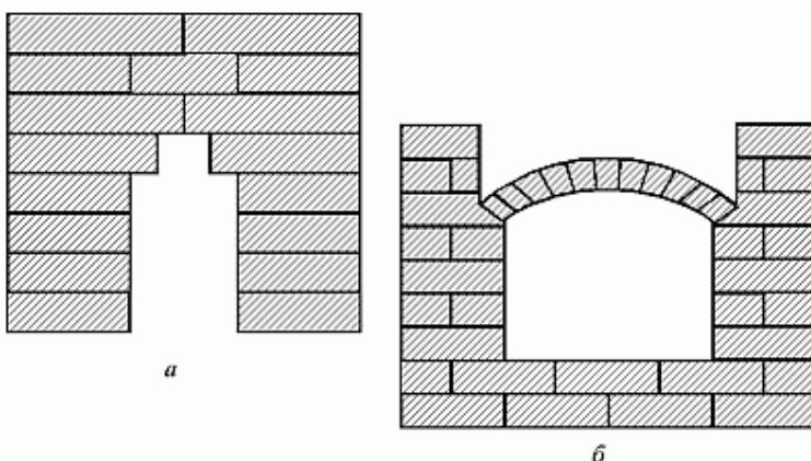
Рис. 29. Печные перекрытия: а — на выпусках; б — арочное (свод)
