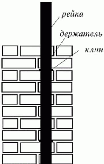
Рис. 13. Крепление порядовки к кладке
