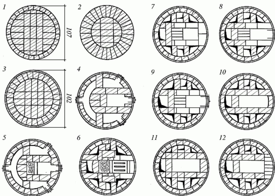
Рис. 64. Круглая печь в металлическом футляре. Последовательность кладки
