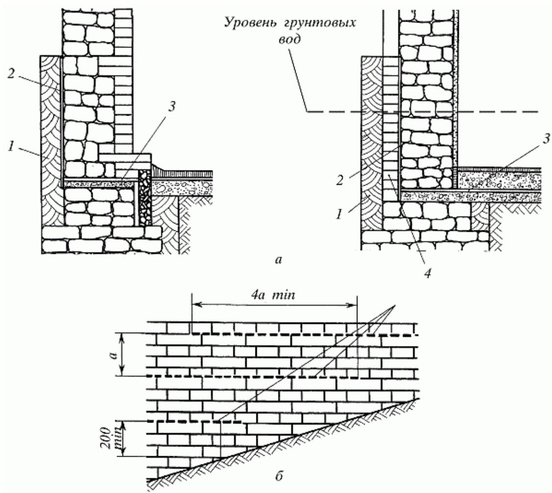
Рис. 44. Гидроизоляция фундаментов: а — вертикальная; б — горизонтальная; 1 — глиняный замок; 2 — оклеочная изоляция; 3 — горизонтальная изоляция; 4 — прижимная стенка
