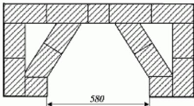
Рис. 92 (продолжение). Последовательность кладки
