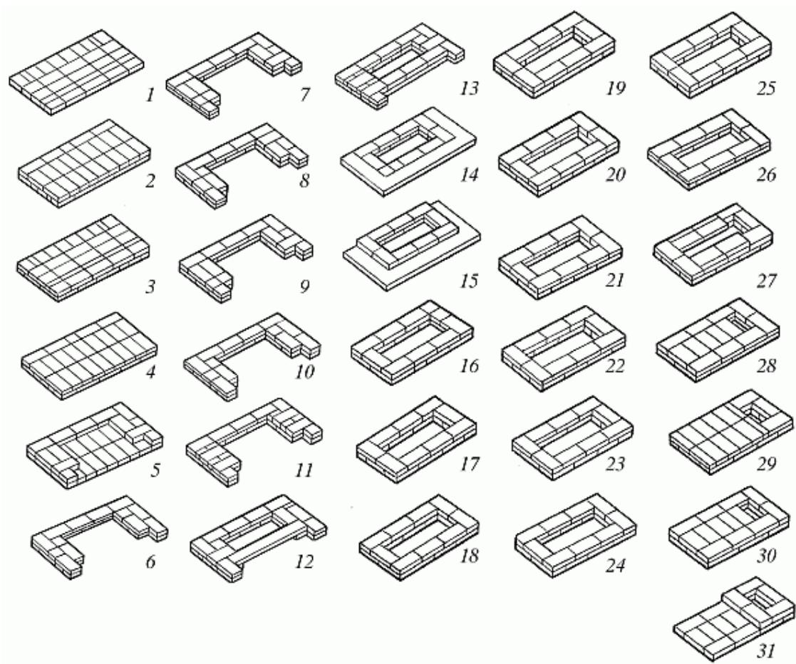
Рис. 88 (продолжение). Последовательность кладки
