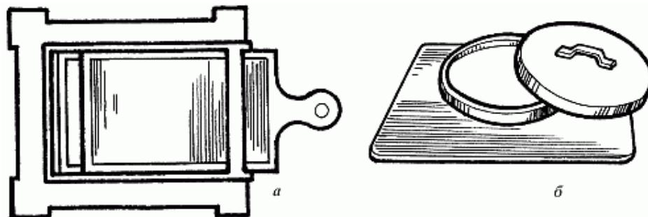
Рис. 6. Запорные приспособления: а — вьюшка; б — задвижка
