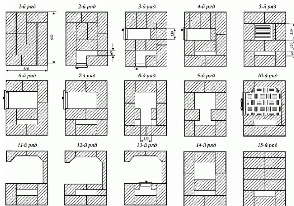
Рис. 69 (продолжение). Последовательность кладки
