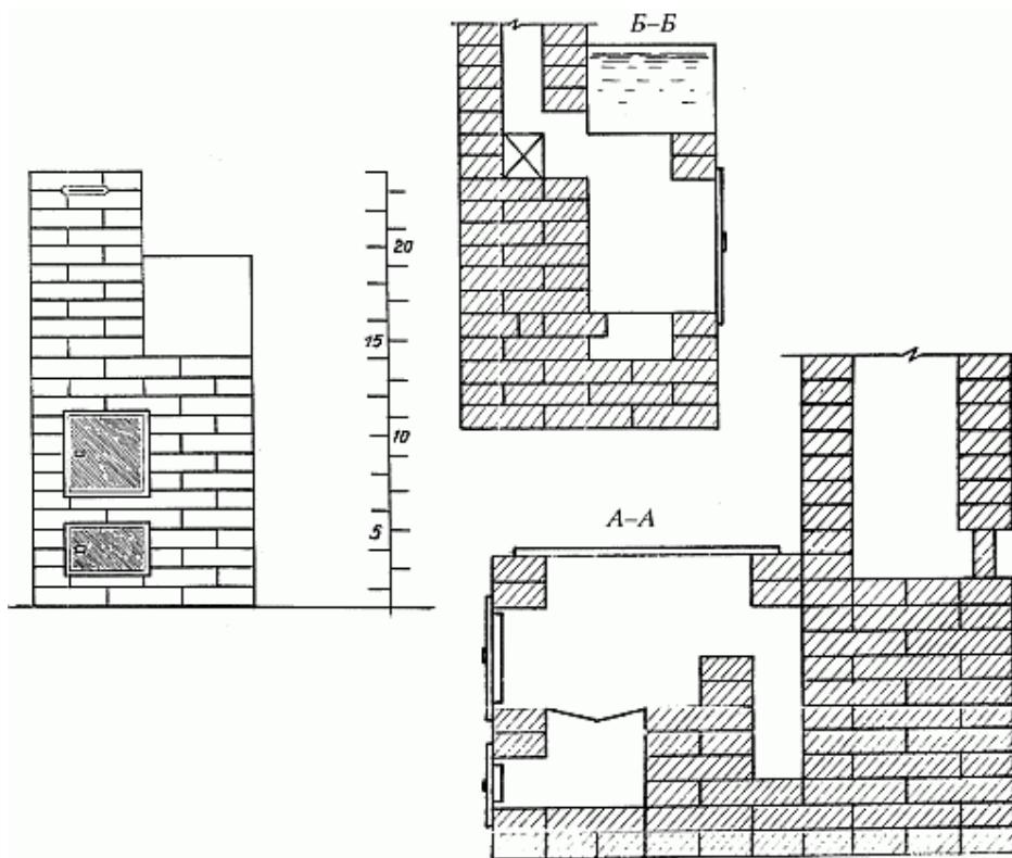
Рис. 58. Малая отопительно-варочная печь. Устройство
