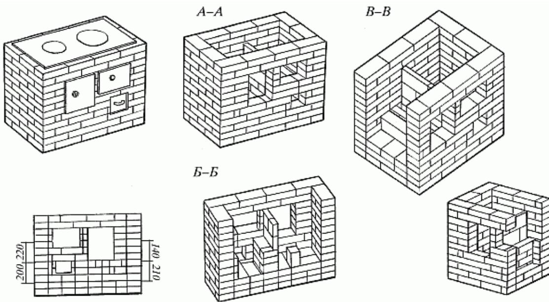
Рис. 78. Кухонная плита с котлом для квартирного отопления
