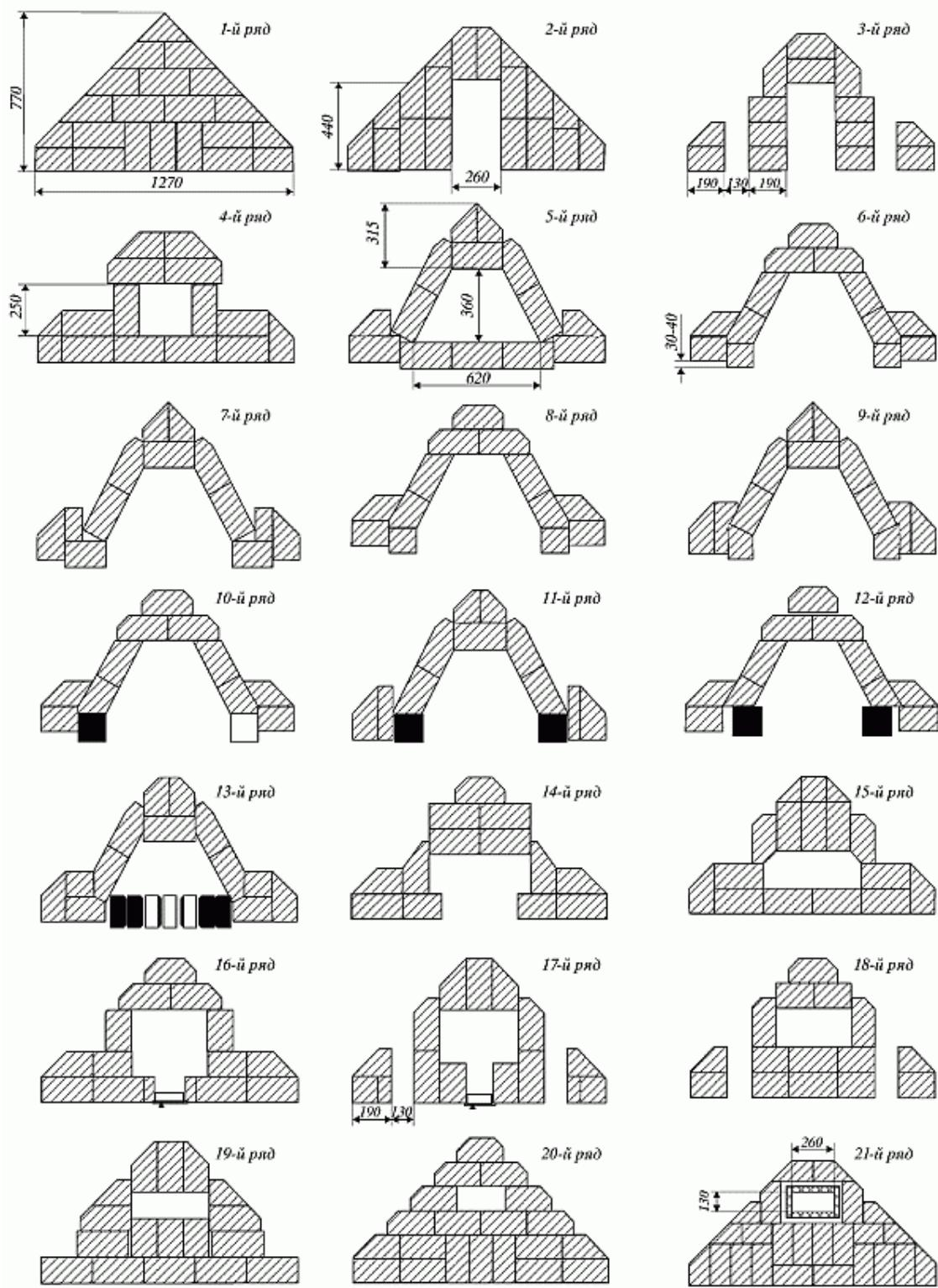
Рис. 91 (продолжение). Последовательность кладки
