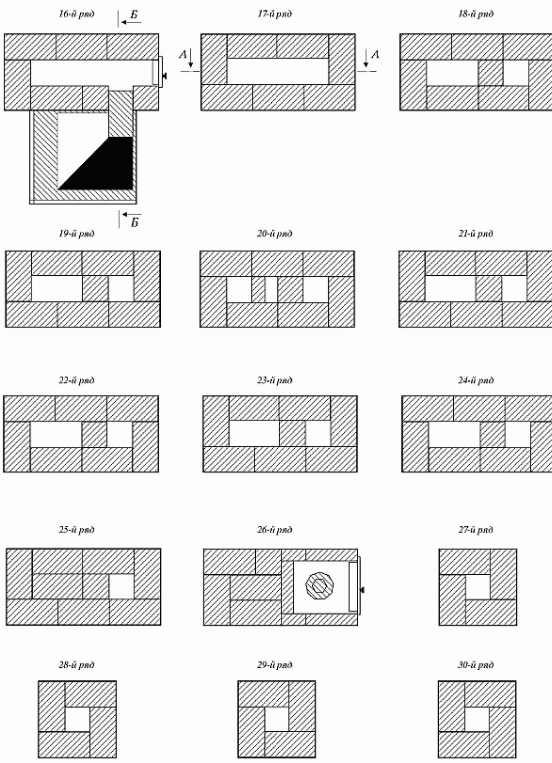
Рис. 87 (продолжение). Последовательность кладки
