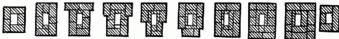
Рис. 38. Последовательность кладки выдры
