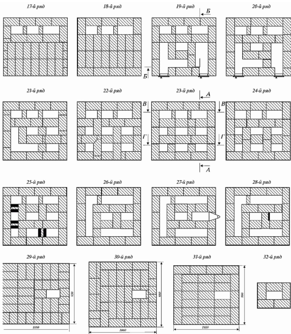
Рис. 71 (продолжение). Последовательность кладки
