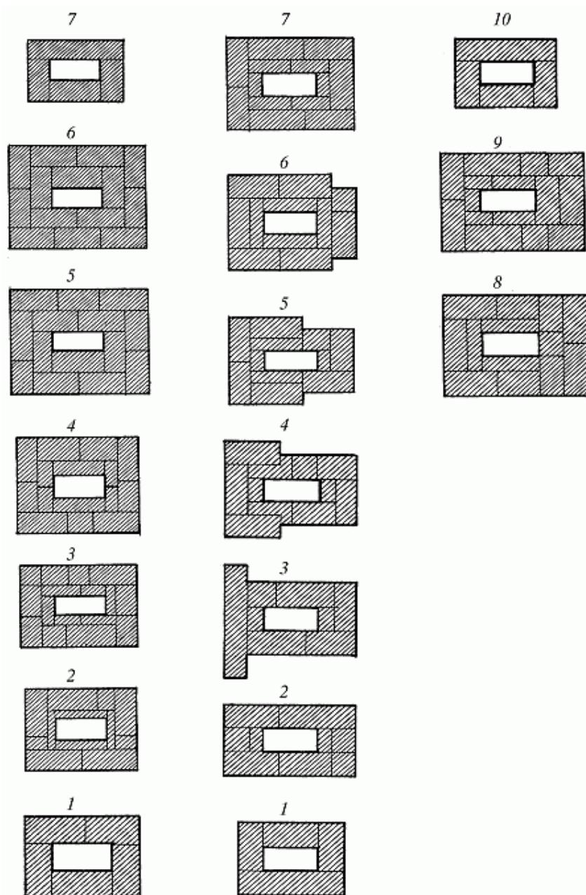
Рис. 52 (продолжение). Труба: порядовки; 1–7 — шейка и распускка; 1–10 — выдра
