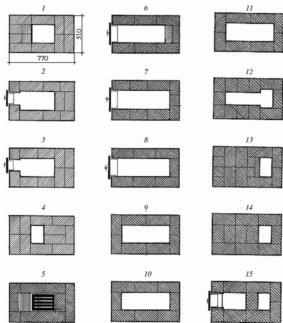
Рис. 51. Печь дачная. Последовательность кладки
