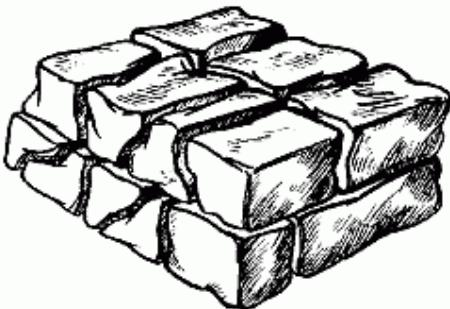
Рис. 21. Кладка, разрезанная вертикальными плоскостями камней
