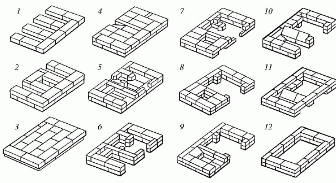
Рис. 76 (продолжение). Последовательность кладки
