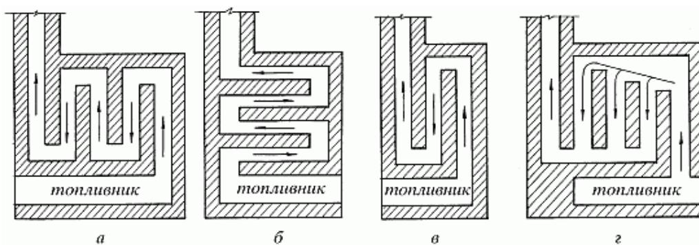
Рис. 1. Схема движения газов в каналах: а — многооборотная; б — однооборотная с одним опускным каналом; в — однооборотная с тремя опускными каналами; г — бесканальная
