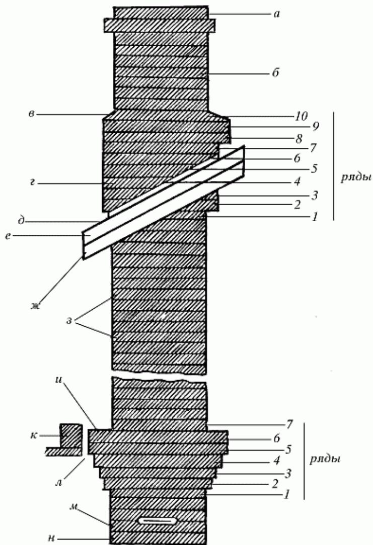
Рис. 36. Устройство дымовой трубы: а — оголовок трубы; б — шейка трубы; в — цементный раствор; г — выдра; д — кровля; е — обрешетка; ж — стропила; з — стойк трубы; и — распушка; к — балка с перекрытием; л — изоляция; м — дымовая задвижка; н — шейка печи
