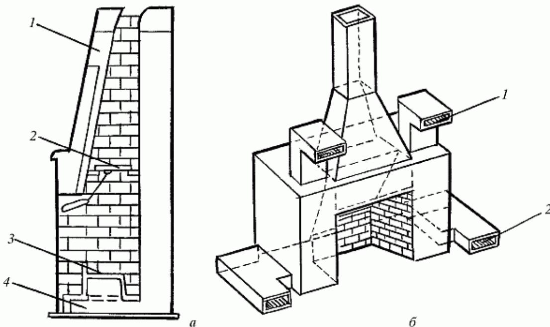
Рис. 83. Камины с подогревом воздуха: а — с калорифером; 1 — выход нагретого воздуха; 2 — дымовая заслонка; 3 — решетка; 4 — вход холодного воздуха; б — с каналом для нагрева приточного воздуха: 1 — выход нагретого воздуха; 2 — вход холодного воздуха
