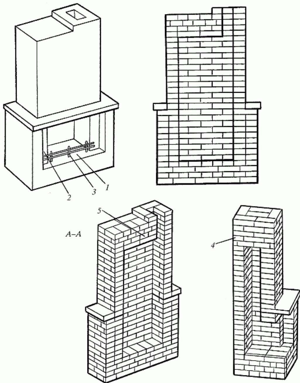
Рис. 88. Простой камина без «дымового зуба»: 1 — подина; 2 — Г-образные штыри для установки каминной решетки; 3 — каминная решетка; 4 — задвижка; 5 — перекрытие газосборника
