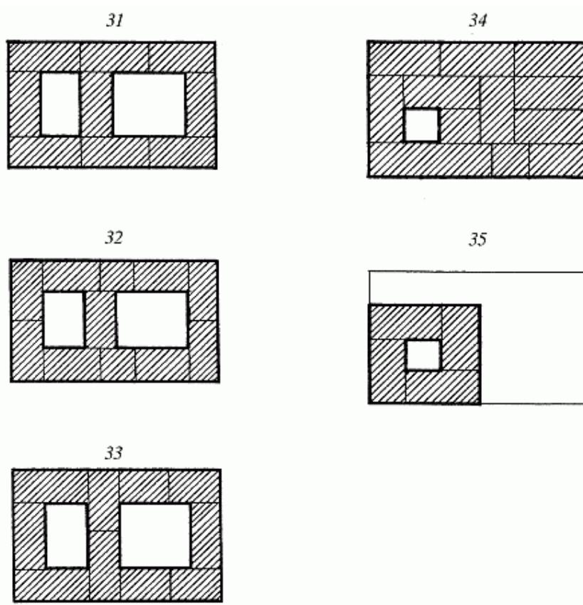
Рис. 51 (продолжение). Печь дачная. Последовательность кладки
