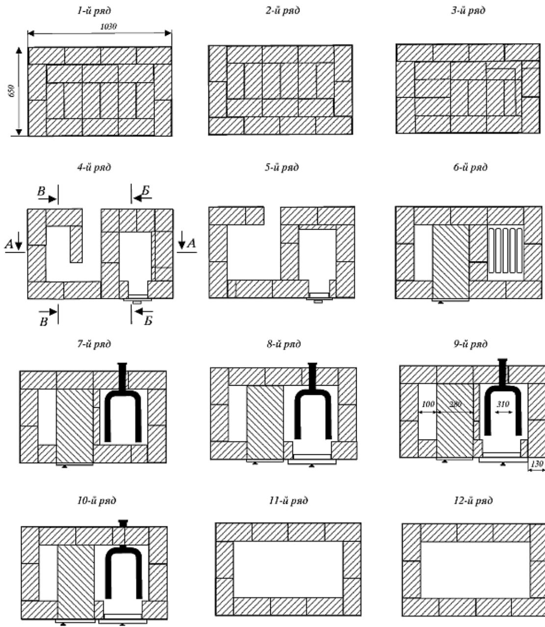
Рис. 78 (продолжение). Последовательность кладки
