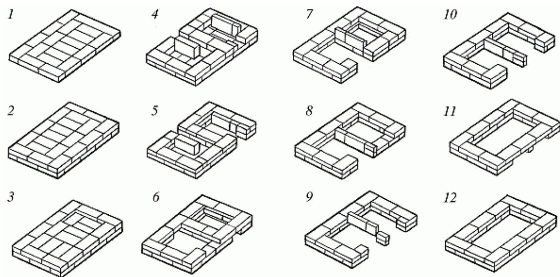
Рис. 78 (продолжение). Последовательность кладки
