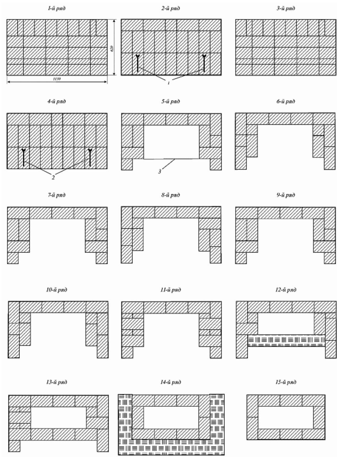
Рис. 88 (продолжение). Последовательность кладки
