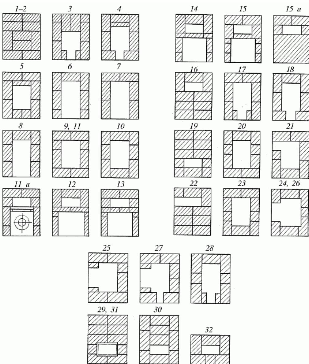
Рис. 61. Малая отопительно-варочная печь с духовкой. Последовательность кладки
