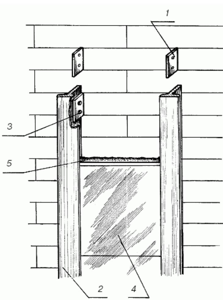
Рис. 42. Облицовка печей и каминов с применением алюминиевых элементов: 1 — алюминиевые полоски с отверстиями; 2 — алюминиевый тавровый профиль (или два уголка); 3 — болты; 4 — керамическая плитка; 5 — глиняный раствор
