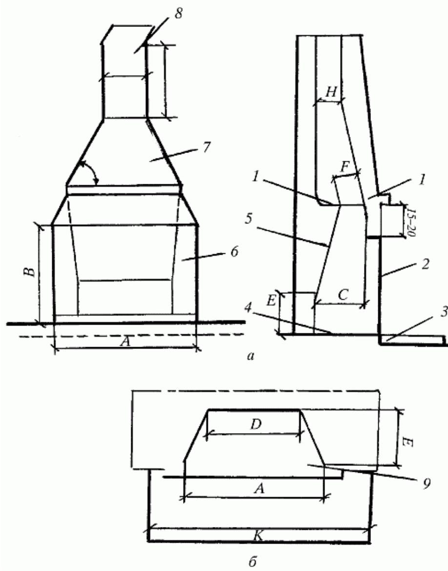
Рис. 85. Камины с боковым расположением дымового канала: а — угольный: 1 — перекидной клапан; 2 — выход нагретого воздуха; 3 — вход холодного воздуха; 4 — днище очага; 5 — задняя стенка; 6 — боковая стенка; 7 — дымовая коробка; 8 — труба б — дровяной: 9 — топочное пространство
