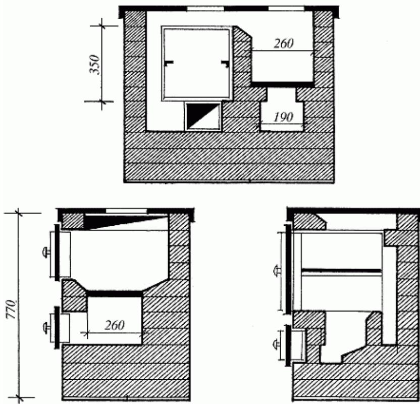
Рис. 74. Кухонная плита с духовым шкафом. Последовательность кладки
