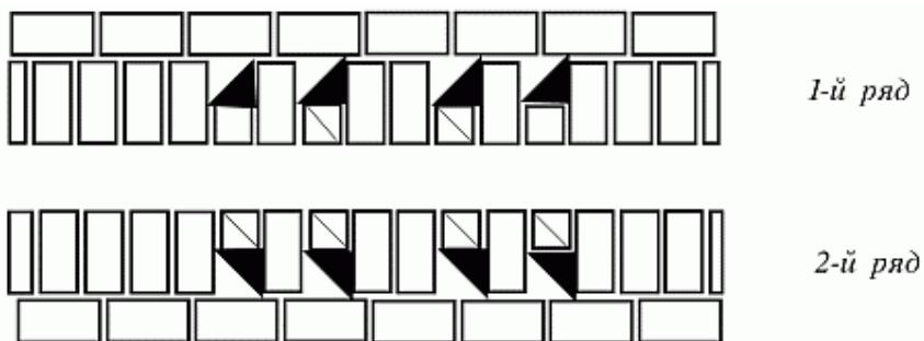
Рис. 32. Каналы в стенах толщиной 1 1/2 кирпича
