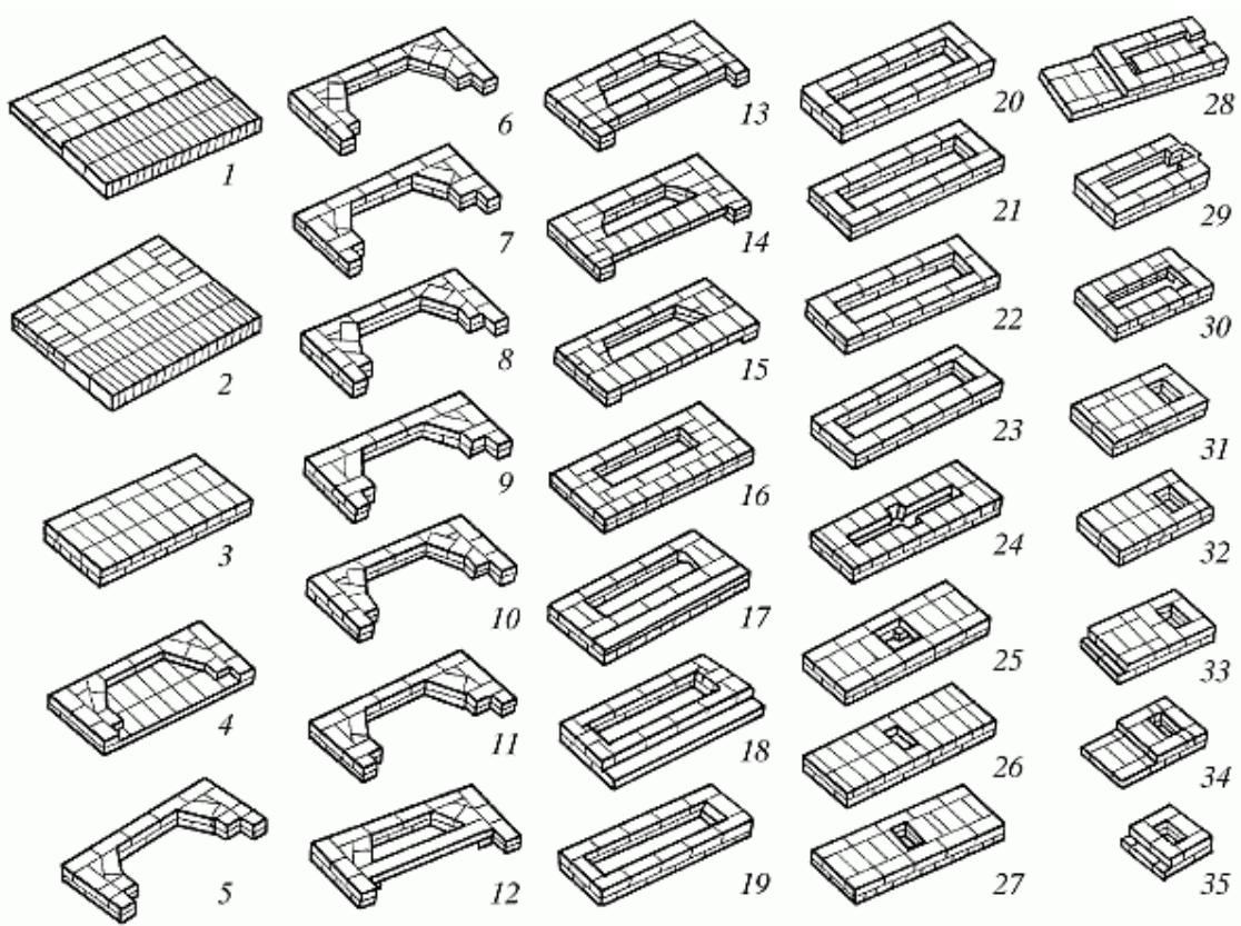
Рис. 89 (продолжение). Последовательность кладки
