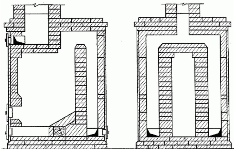
Рис. 63. Круглая печь в металлическом футляре. Устройство
