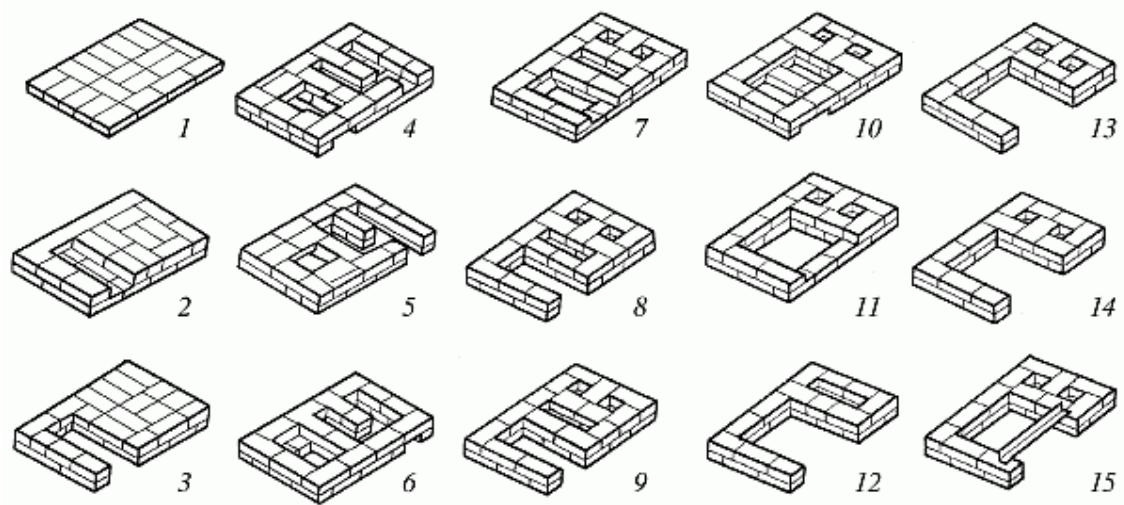
Рис. 70 (продолжение). Последовательность кладки
