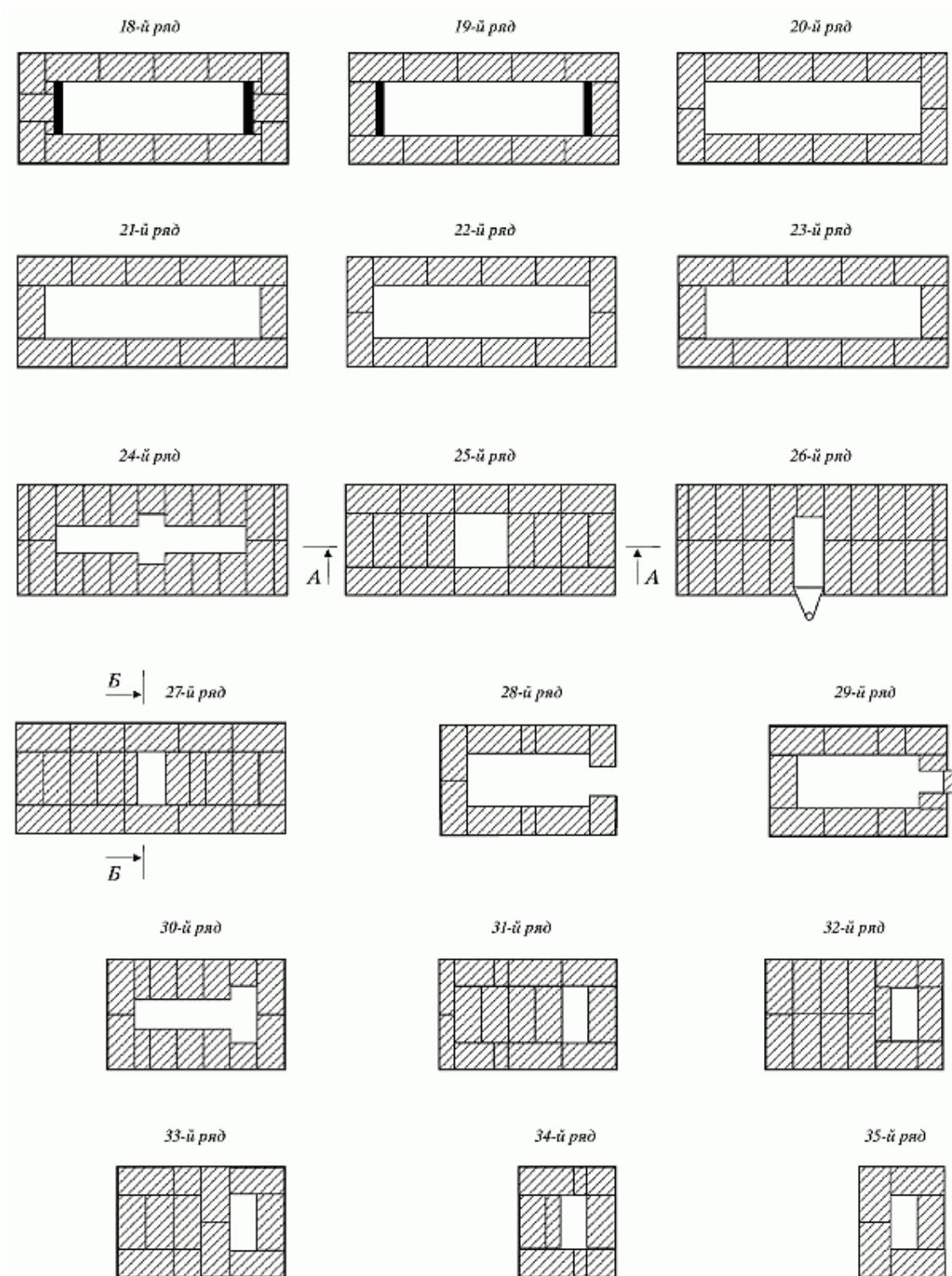
Рис. 89 (продолжение). Последовательность кладки
