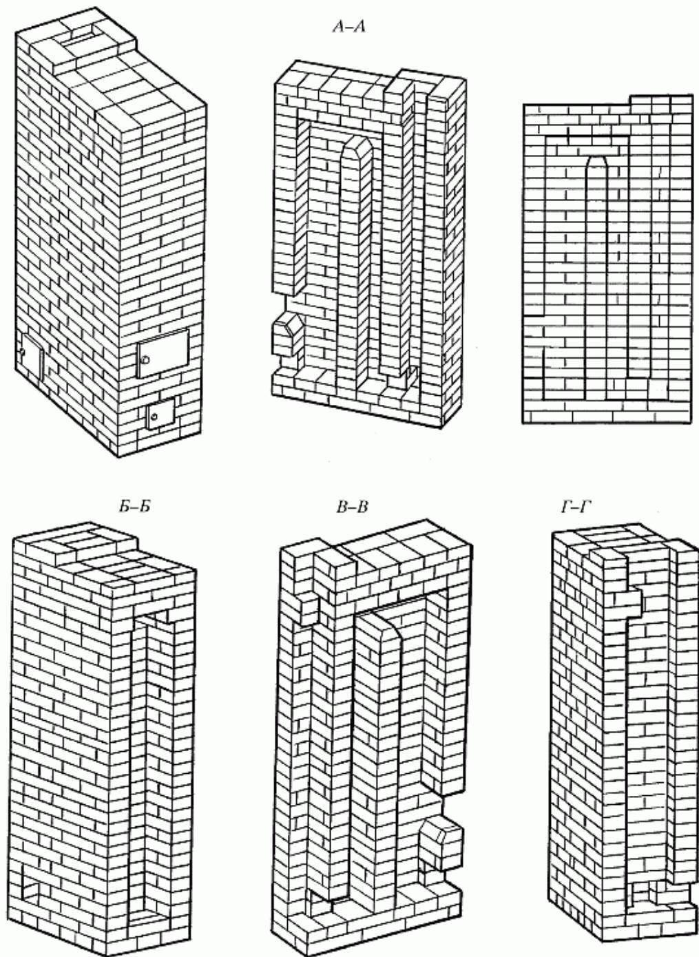
Рис. 66. Прямоугольная отопительная печь с тремя вертикальными каналами
