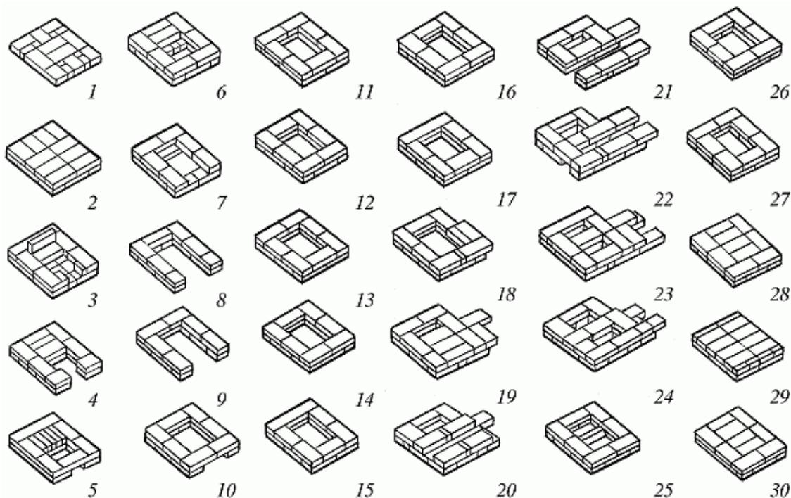
Рис. 65 (продолжение). Последовательность кладки
