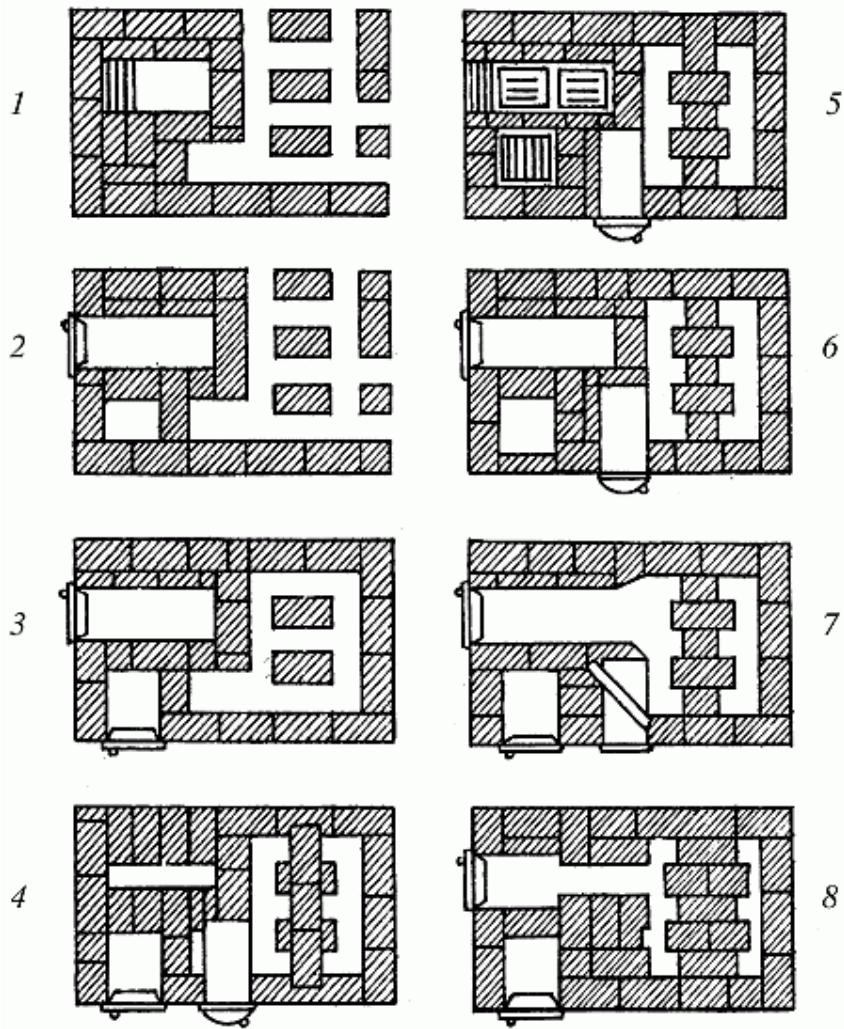
Рис. 54. Печьэкономка, вариант без водогрейной коробки. Последовательность кладки
