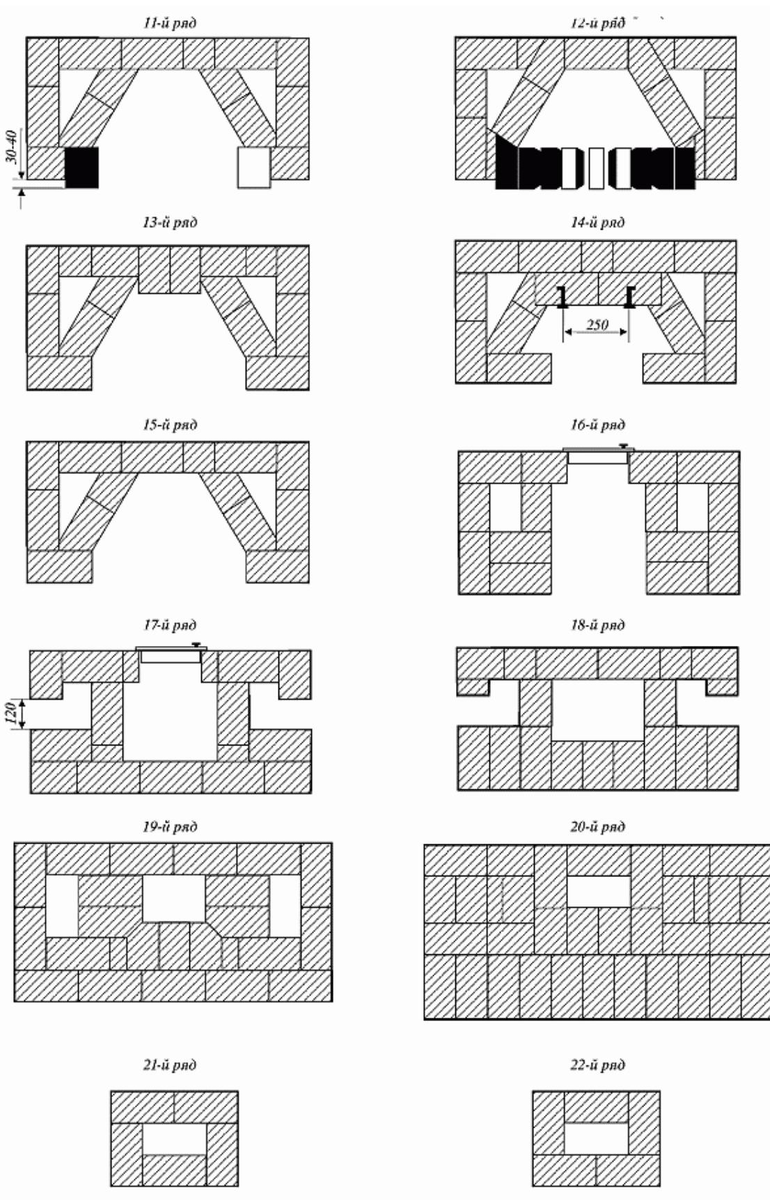
Рис. 92 (продолжение). Последовательность кладки
