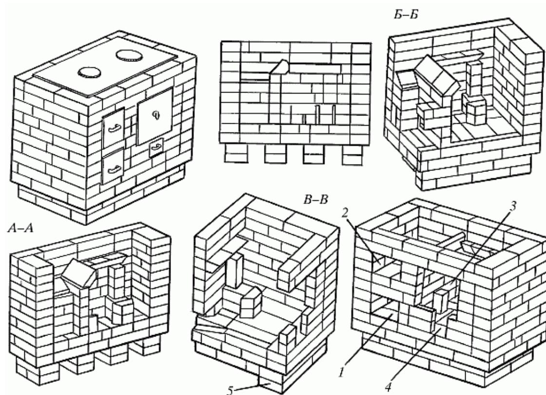
Рис. 76. Кухонная плита на шанцах: 1 — поддувальная дверка; 2 — топочная дверка; 3 — духовой шкаф; 4 — дверка чистки; 5 — шанцы
