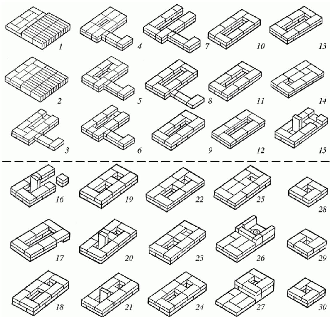
Рис. 87 (продолжение). Последовательность кладки
