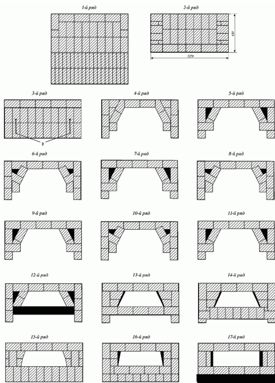
Рис. 89 (продолжение). Последовательность кладки: 2 — балка из огнеупорного бетона
