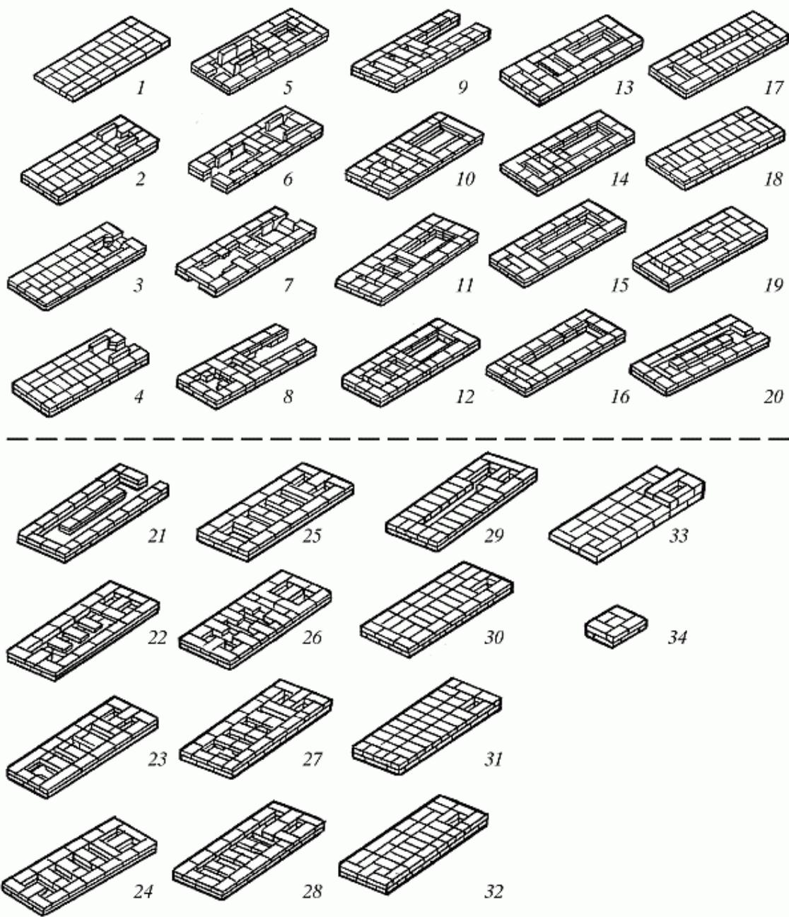
Рис. 68 (продолжение). Последовательность кладки
