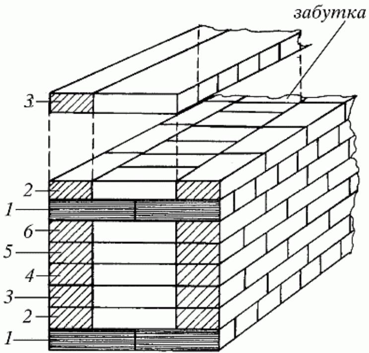
Рис. 28. Многорядная система перевязки: 1 — тычковый ряд; 2—6 — ложковые ряды
